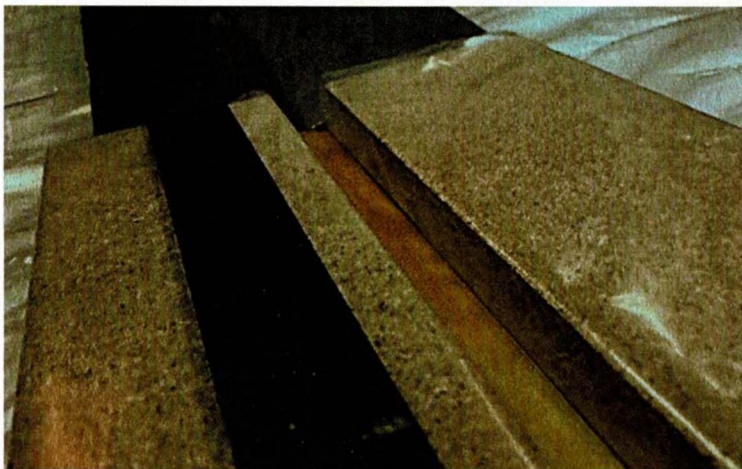
Рис.1. Прибор для определения липкости препрегов методом «катящегося шарика».
