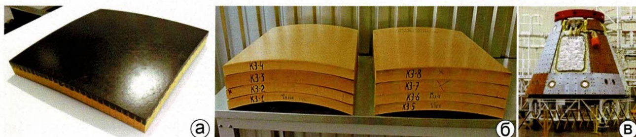
Рис.2. Сборочные элементы, для изготовления теплозащитного покрытия лобового экрана (а) и боковой поверхности (б) космического корабля «Орел».
