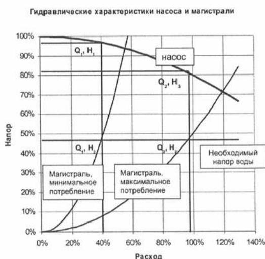
Рисунок 4 Зависимости работы насоса и сети
