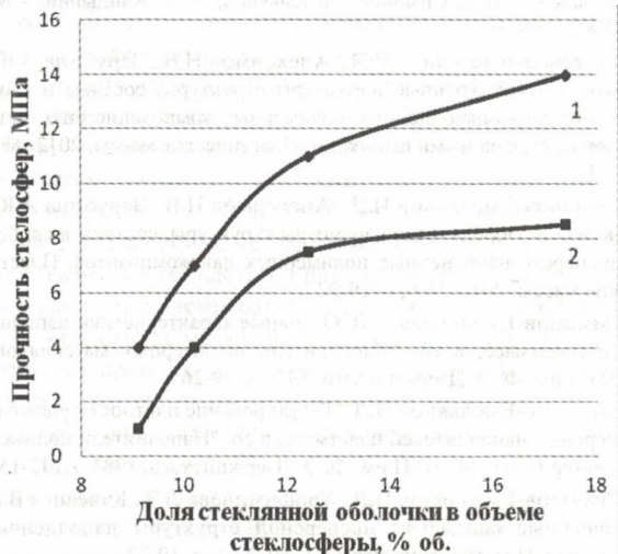
Рис. 2. Зависимость прочности в воде (1) и прочности при уплотнении (2) стеклянных микросфер марки МС-ВП-А9 от доли стеклянной оболочки в объеме полых стеклянной микросферы.
