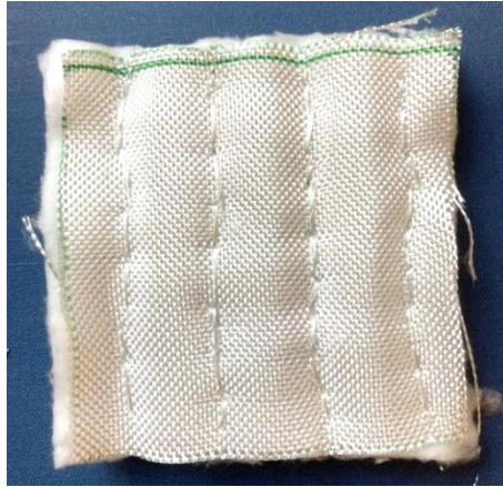
Рис. 3. Внешний вид образца прошивного мата
